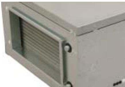
Водяной воздушонагреватель установлен после вентилятора. Конструкция воздушонагревателя обеспечивает простое подключение трубопровода горячей воды с торцевой стороны агрегата. Нагреватель представляет собой теплообменник, выполненный из медных труб с алюминиевым оребрением в корпусе из оцинкованной листовой стали.
