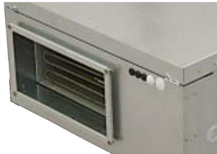
Электрический воздушонагреватель установлен после вентилятора. Нагревательный элемент выполнен из нержавеющей стали. Воздушонагреватель оснащен защитой от перегрева как с ручным, так и с автоматическим возвратом в рабочее состояние. Электрический воздушонагреватель поддерживает комфортную температуру приточного воздуха даже при низкой температуре наружного воздуха (см. стр. 14).
