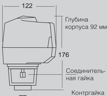
**ВНИМАНИЕ!** При соединении привод и клапан перекрывают друг друга на 15 мм.
