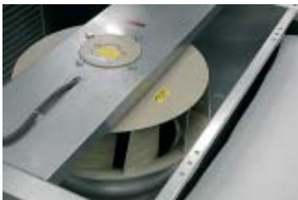
Агрегаты ТА оборудованы бескорпусным радиальным вентилятором с непосредственным приводом от электродвигателя с внешним ротором. Лопатки рабочего колеса загнуты назад. Вентилятор обеспечивает оптимальные рабочие характеристики: расход воздуха, уровень шума и КПД. 2-ступенчатое регулирование скорости вентилятора осуществляется с помощью встроенного трансформатора. Вентилятор легко извлекается из корпуса для осмотра и чистки. Для демонтажа вентилятора достаточно ослабить 4 винта.
