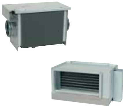
**CWK**, водяной воздухоохладитель для круглых воздуховодов. Теплообменник изготовлен из медных труб с алюминиевым оребрением. Корпус изготовлен из оцинкованной листовой стали. Для осмотра и технического обслуживания в корпусе агрегата выполнены сервисные люки. Водяной воздухоохладитель подсоединяется к воздуховоду с помощью соединительных фланцев с резиновым уплотнением. Максимальная рабочая температура составляет 150°C, максимальное рабочее давление—1,6МПа (16бар).
